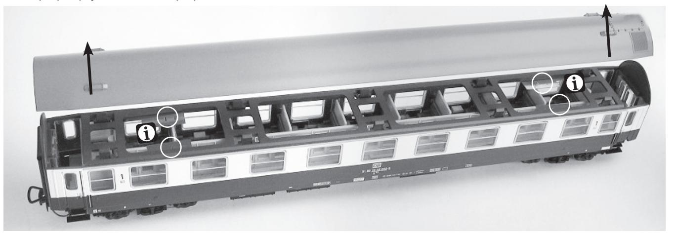
**(DE) Montage Radschleifer • (GB) Installation of wheel pick-up shoes • (FR) Montage des frotteurs d'essieux
