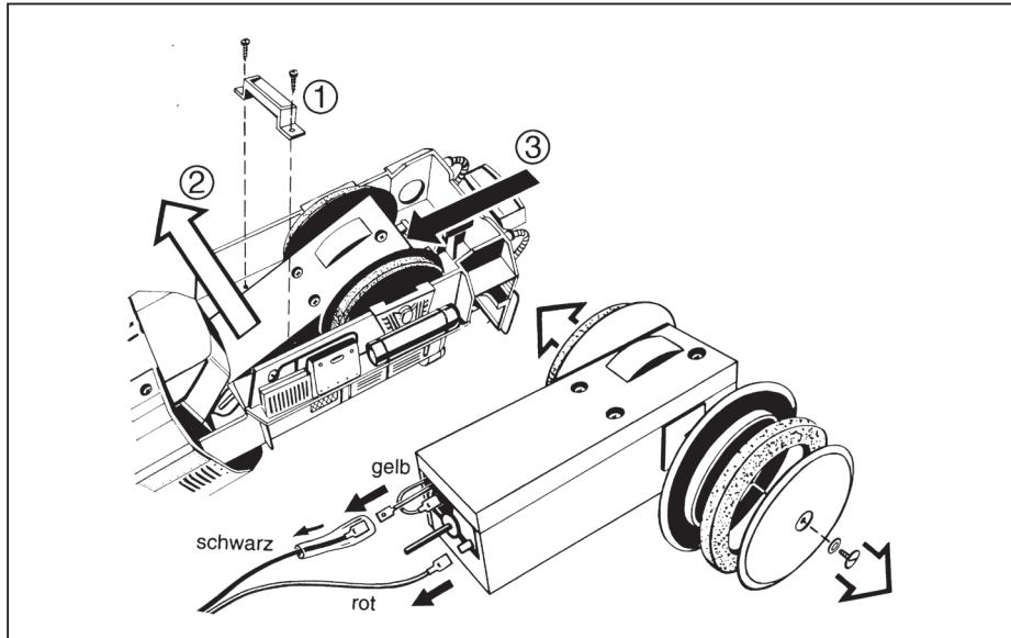
Bild 2, Austauschen der Reinigungsräder
